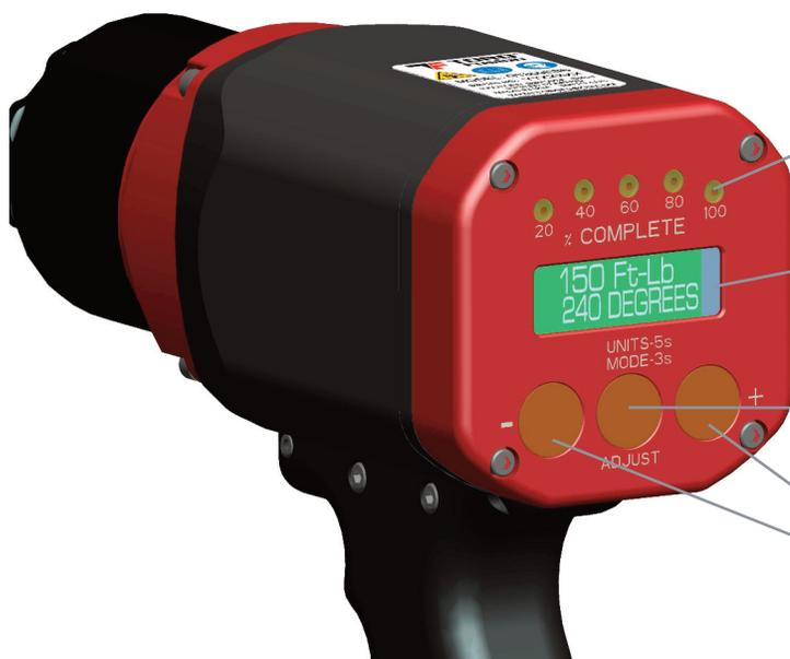
5 LED gialli indicano la percentuale di coppia raggiunta. Tutti i LED diventano verdi quando viene raggiunta con successo la coppia impostata. I LED si illuminano di rosso in caso di anomalie nel serraggio.
